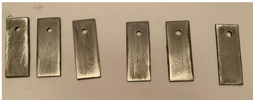
1 Сурет – Тоттануға қарсы белсенділігін зерттеу жүргізуге арналған пластинкалар
